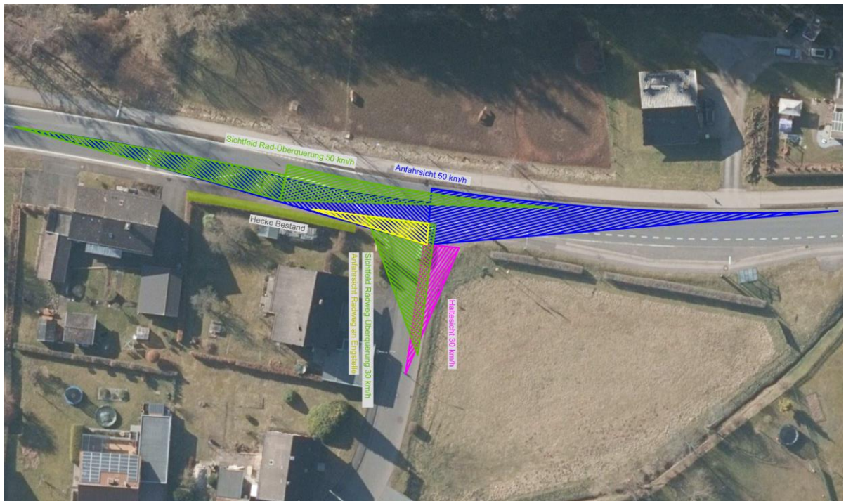
Abbildung 5: Einmündungsbereich "Dommersbach" in L17: Überprüfung der Sichtfelder
